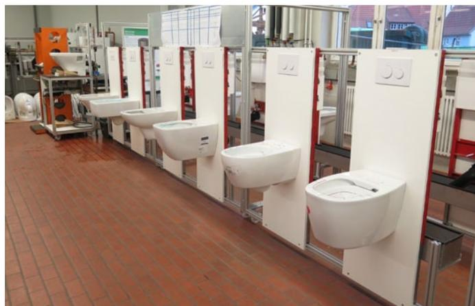
den wie folgt verteilt: Bei allen fünf Versuchen alles Papier ausgespült 100 Punkte. Bei vier von fünf Versuchen alles Papier ausgespült (ein Fehlversuch) 50 Punkte. Bei nur drei von fünf Versuchen (zwei Fehlversuche) gab es keinen Punkt. Die Spannweite der Ergebnisse bei diesen Versuchen reichte von 41 bis 100 Punkte (Tabelle 3).
