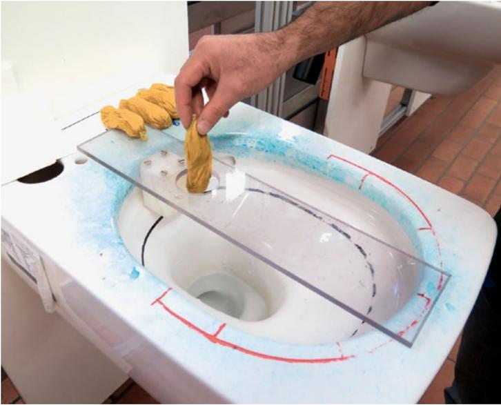
Ausspültest mit Knödeln und Papier: Da es praxisfern ist, Papier und Prüfkörper separat zu spülen (in der DIN 997 vorgeschrieben), wurde zusätzlich ein praxisbezogener Test mit fünf speziellen Prüfkörpern à 50 g und 16 Blatt Papier durchgeführt.
